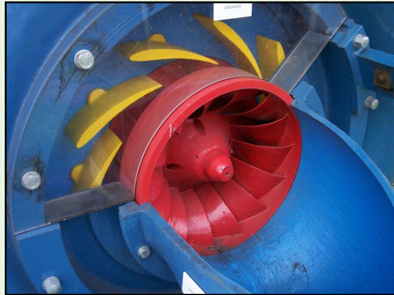
Links gesloten en rechts geopende leidschoepen.
