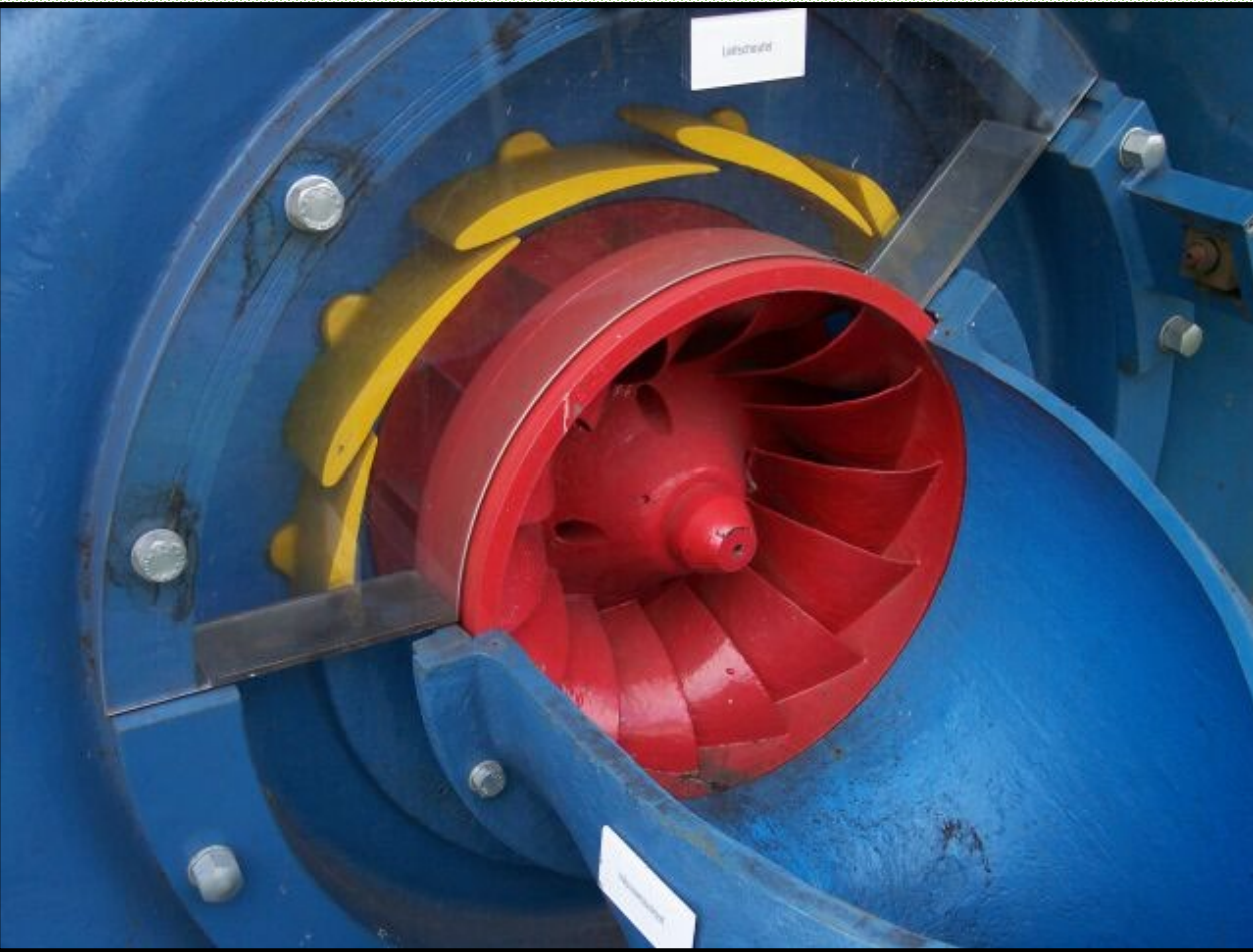
Links gesloten en rechts geopende leidschoepen.
