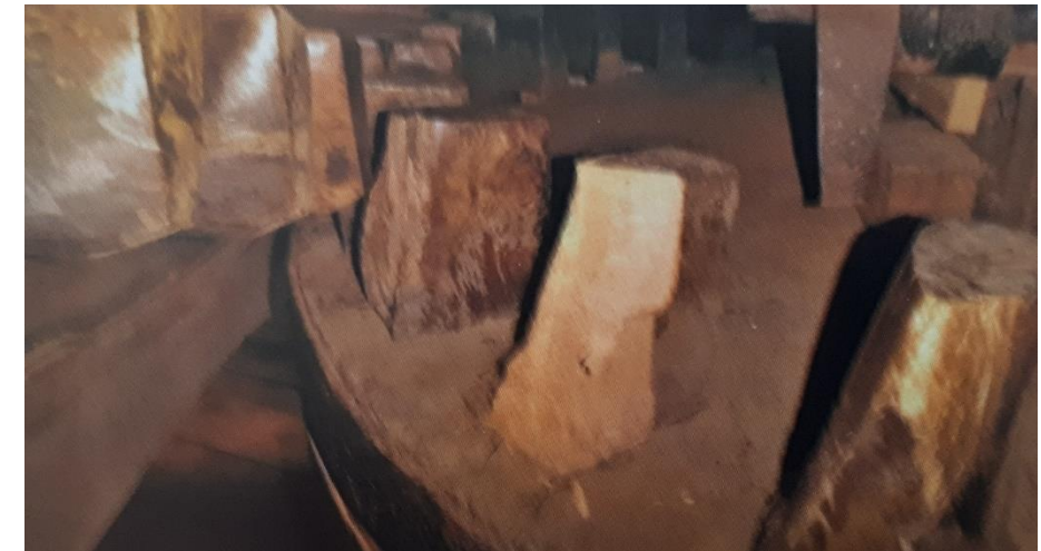
Kammen aswiel raken onderste rondselschijf
