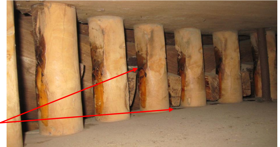
Kammen aswiel raken onderste rondselschijf
